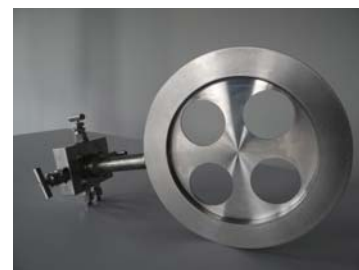
Фото 4 : Компактный расходомер (2 интегрированные отвода давления) с 4 отверстиями RF с манифольдом и датчиком дифференциального давления
