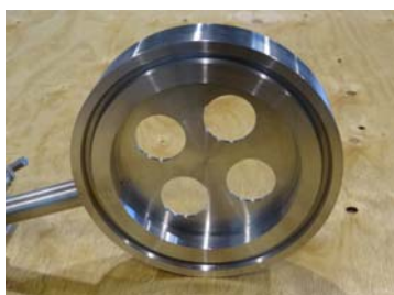
Фото 5 : Компактный расходомер (2 интегрированные отвода давления) с 4 отверстиями RTJ
