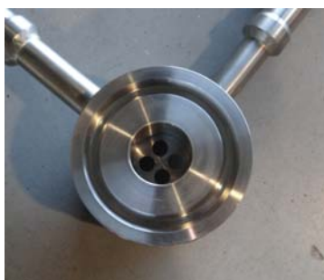
Фото 2 : Моноблок RTJ с 4 отверстиями и 2 центрированными штуцерами для отвода давления
