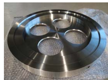
Фото 3 : Моноблок RF с 4 отверстиями и отводами давления
